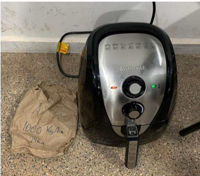
Figura 7 – Fritadeira elétrica secando as amostras
